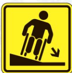
ТП17 Знак «Осторожно! Крутой поперечный уклон вправо»
